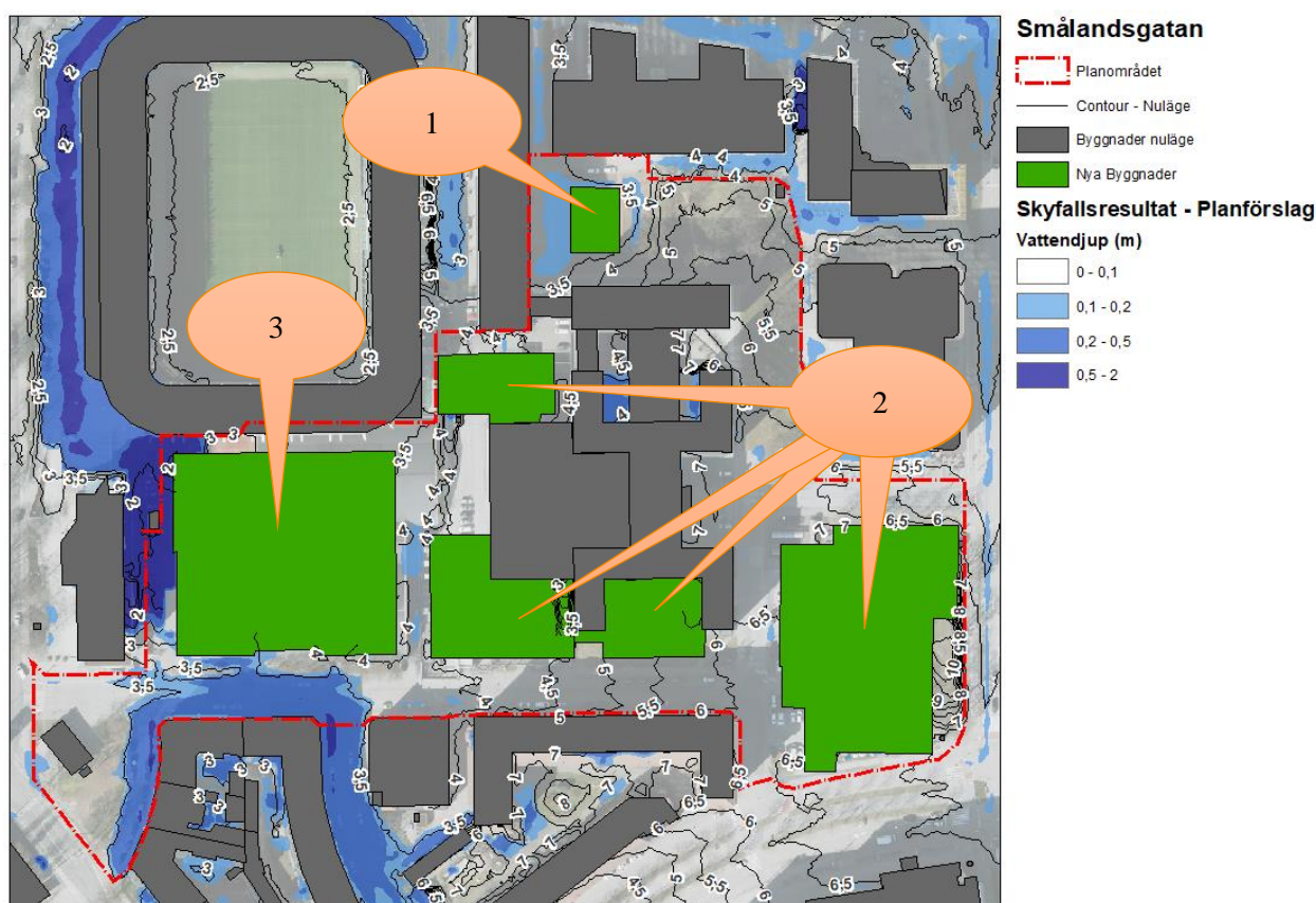
Figur 8: Skiss med de nya byggnaderna, 1&2 är klassat som samhällsviktig infrastruktur (undantag södra byggrätten på Ernst fontells plats) och byggnad 3 är en vanlig byggnad. Översvämningensresultat med planförslaget utan åtgärd.
